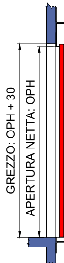
SEZIONE TELAIIO PORTE NF (EI120)
